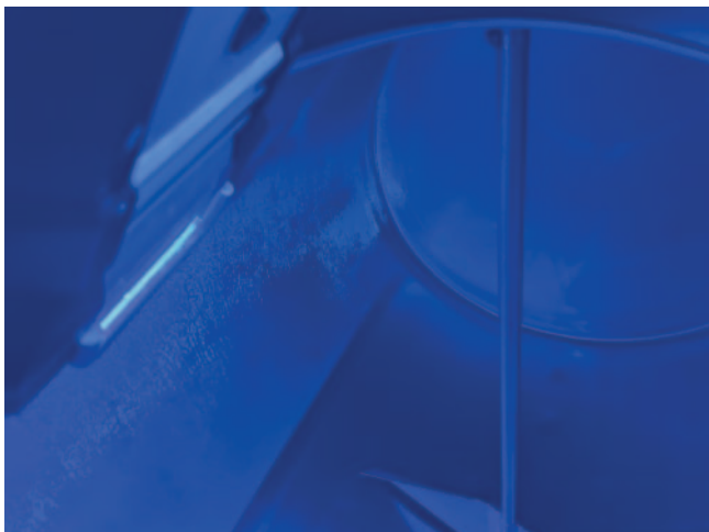
Sichtbare Ablagerungen an den Wänden des Milchtanks
